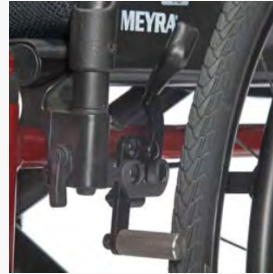
Frein unique avec des forces d'actionnement très faibles
