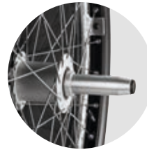
Essieu surdimensionné pour une énorme stabilité
